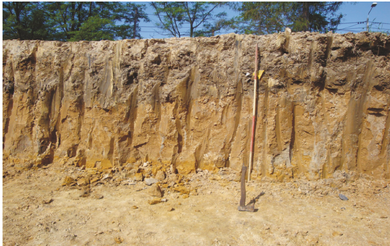
Fot. 1. Gлина pylasta w wykopie fundamentowym – warstwa I
