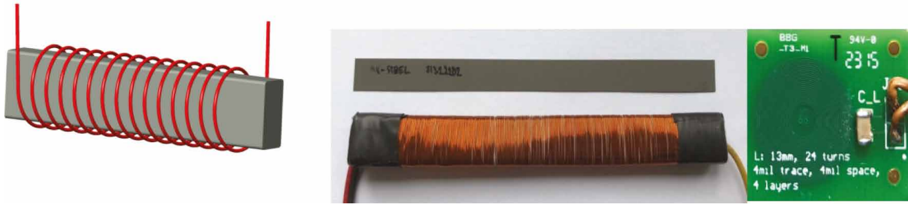
Rys. 5. Próbkę otwartą – schemat i realizacja – oraz próbkę spiralną PCB
