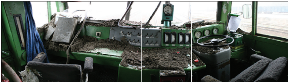
Fot. 8. Widok wnętrza kabiny maszynisty lokomotywy po wypadku
