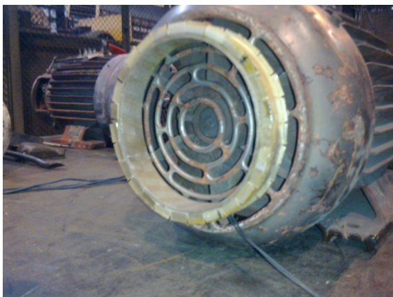
Rys.3. Cewka zamontowana na badanym silniku
