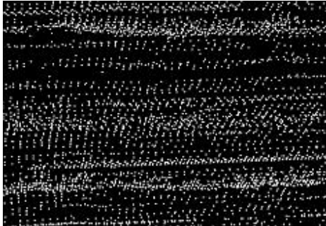
Rys. 7. Przykład danych niespełniających warunku równomierności rozkładu punktów z powodu nachylenia skanera w kierunku lotu (kąt \phi )
