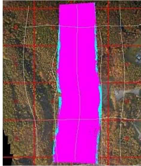
Rys. 3. Porównanie wyników przycięcia po kącie od pionu: kolor różowy - Terrascan i kolor seledynowy - LiMON
