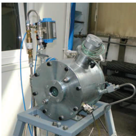
Rys.5. Komora do prowadzenia badań wybuchowości mieszanin gazowych [11]
