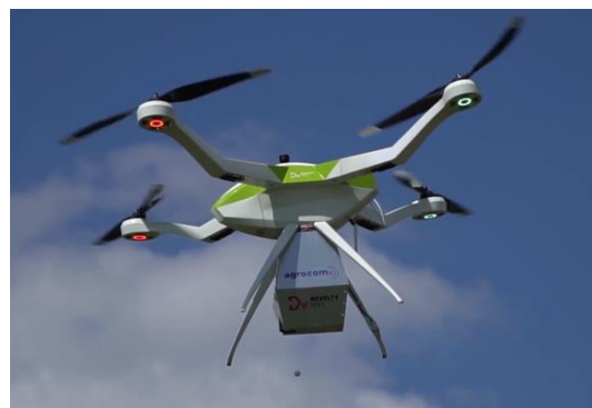
Rys. 4. Platforma wielowirnikowa z podwieszonym zasobnikiem agro.
