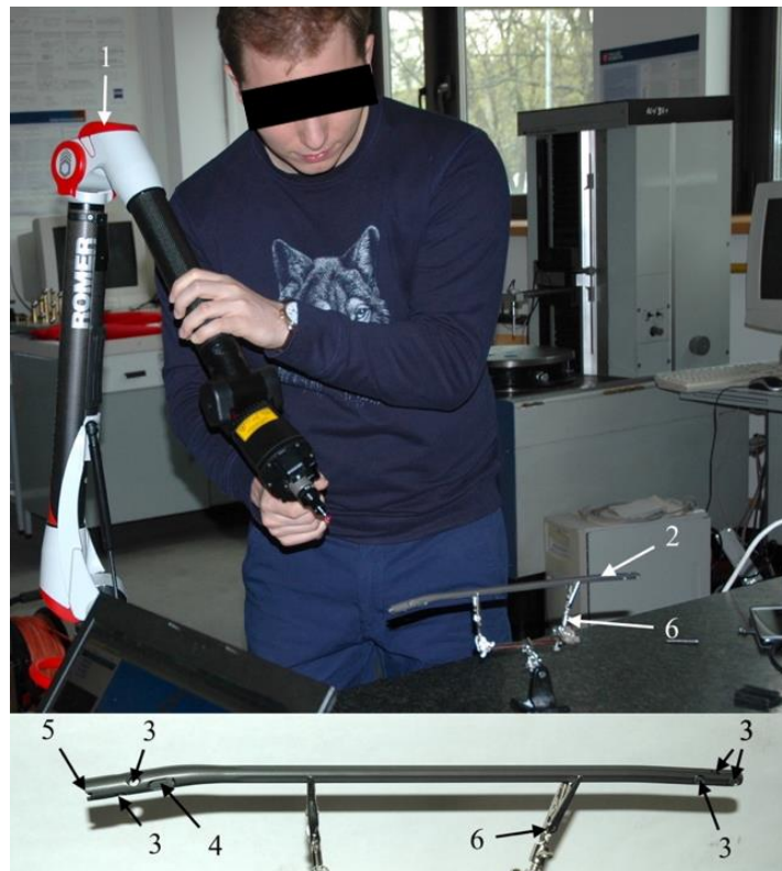
Rys.1. Skanowanie zespolenia śródszpikowego: 1 – skaner laserowy, 2 – gwóźdź śródszpikowy, 3 – otwory statyczne, 4 – otwór dynamiczny, 5 – otwór pilotażowy, 6 – statyw
