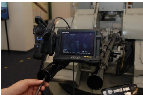
Rys. 3. Wideoskop podczas badań luf armat morskich w PBRiA: a) wideoskop na stanowisku diagnostycznym w PBRiA b) ślady korozji na powierzchni wewnętrznej przewodu lufy
