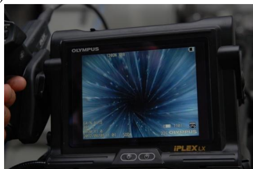
Rys. 3. Wideoskop podczas badań luf armat morskich w PBRiA: a) wideoskop na stanowisku diagnostycznym w PBRiA b) ślady korozji na powierzchni wewnętrznej przewodu lufy
