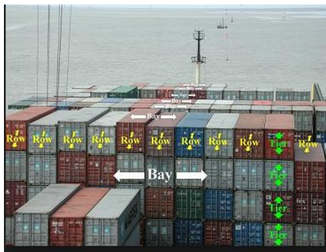
Rys. 2. Układ rzędów, stosów oraz warstw kontenerów na pokładzie statku kontenerowego. Źródło: www.containerhandbuch.de
