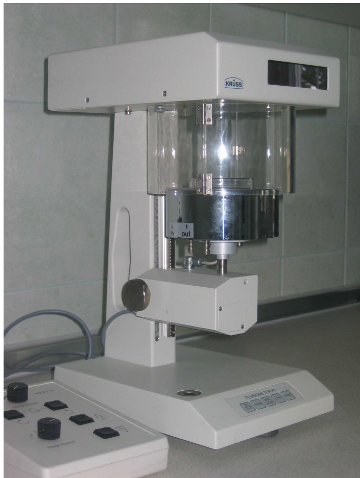
Fot.1 Widok ogólny stanowiska do oznaczania napięcia powierzchniowego ( \gamma_s ) na granicy faz ciec-zgaz oraz napięcia powierzchniowego na granicy dwóch nie mieszających się ciecztzw. napięcia międzyfazowego ( \gamma_i )
