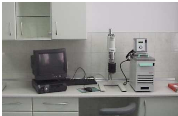
Fot.2 Stanowisko do pomiaru lepkości dynamicznej wiskozymetrem rotacyjnym z układem termostatujuącym i jednostką sterującą
