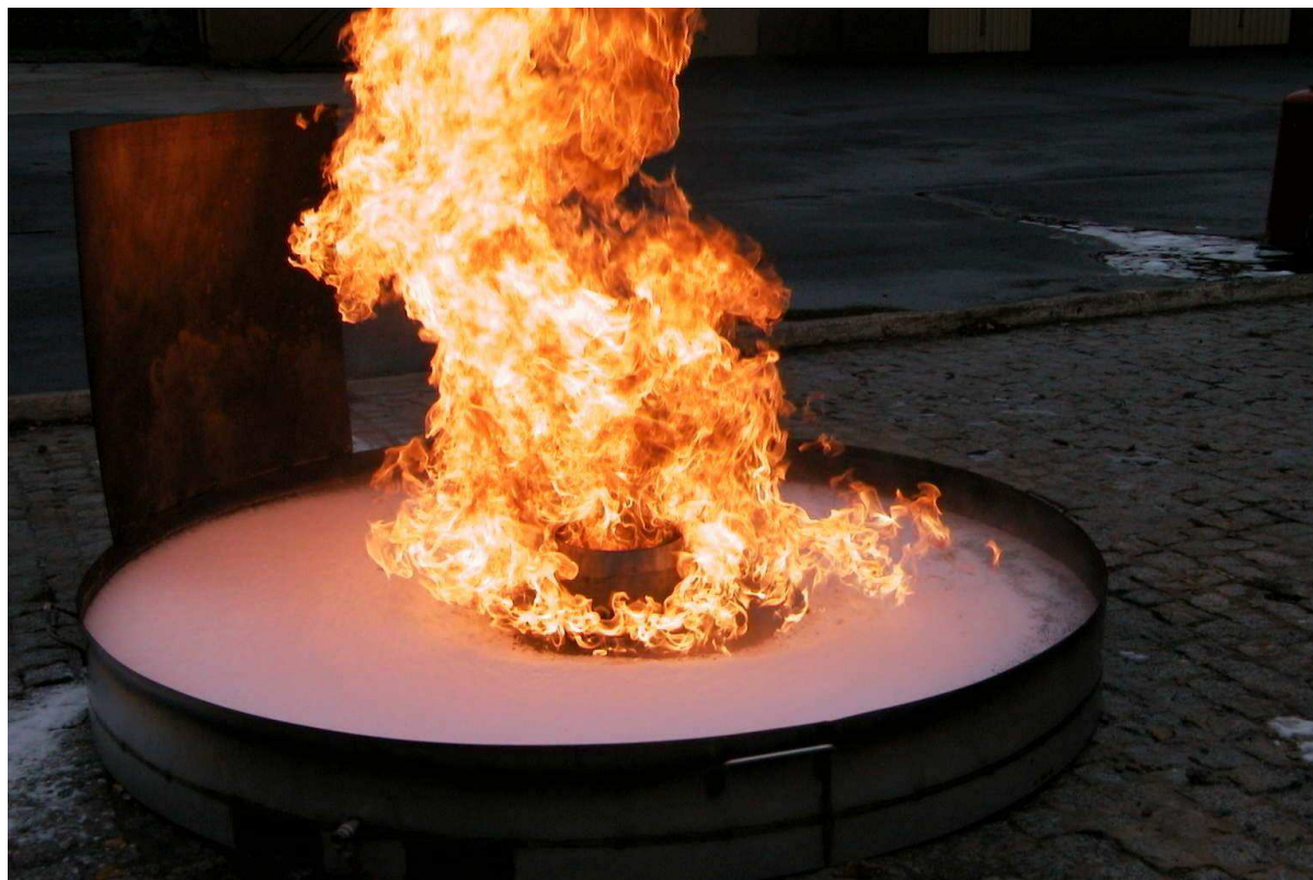
Fot. 3 Badanie nawrotu palenia wg PN-EN 1568 cz.3
