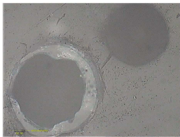
Rys. 18. Zmienna grubość ścianek mikrosfer (Chiny). Światło odbite, 1N, pow. 200x Fig. 18. Cenospheres spherical in shape characterized by variable shell thickness (China). Reflected light, 1N, magn. 200x
