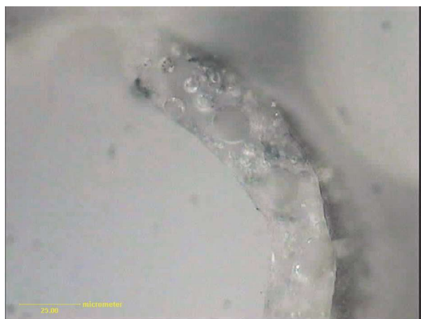
Rys. 10. Widoczne pory w ściance mikrosfery (Dolna Odra). Światło odbite, 1N, pow. 500x
