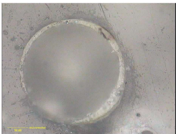
Rys. 17. Mikrosfera o sferycznym kształcie i zmiennej grubości ścianki (Chiny). Światło odbite, 1N, pow. 200x Fig. 17. Cenosphere spherical in shape and variable thickness of shell (China). Reflected light, 1N, magn. 200x
