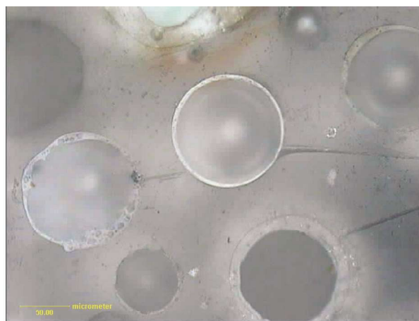
Rys. 11. Mikrosfery o sferycznych kształtach i różnej grubości ścianek (Dolna Odra), Światło odbite, 1N, pow. 200x
