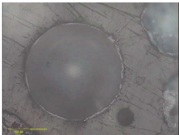
Rys. 23. Mikrosfera o idealnie sferycznym kształcie (Kazachstan). Światło odbite, 1N, pow. 100x
