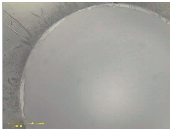
Rys. 24. Mikrosfera o idealnie sferycznym kształcie (Kazachstan). Światło odbite, 1N, pow. 200x
