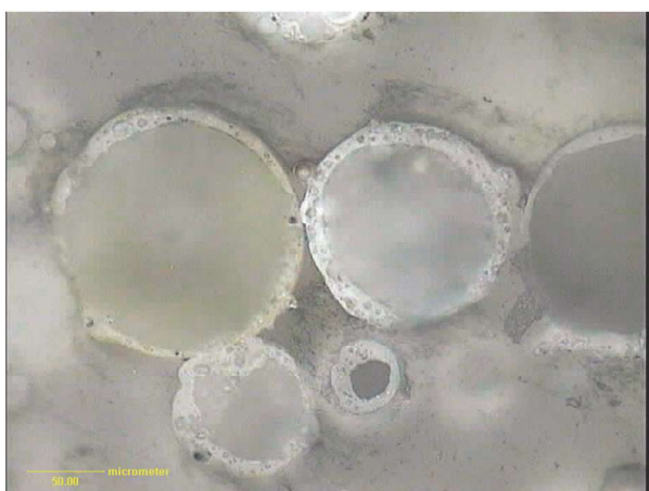
Rys. 12. Mikrosfery o porowatych ściankach (Dolna Odra). Światło odbite, 1N, pow. 200x
