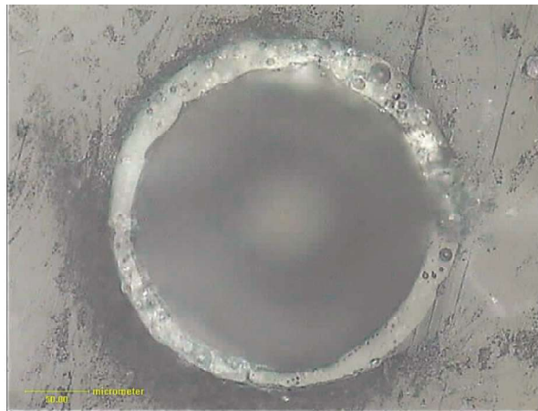
Rys. 4. Mikrosfera o sferycznym kształcie i porowatej ściance (Opole). Światło odbite, 1N, pow. 200x
