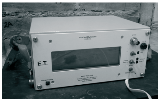
Rys. 4. Przenośny miernik TDR (FOM - Field Operated Multimeter).
