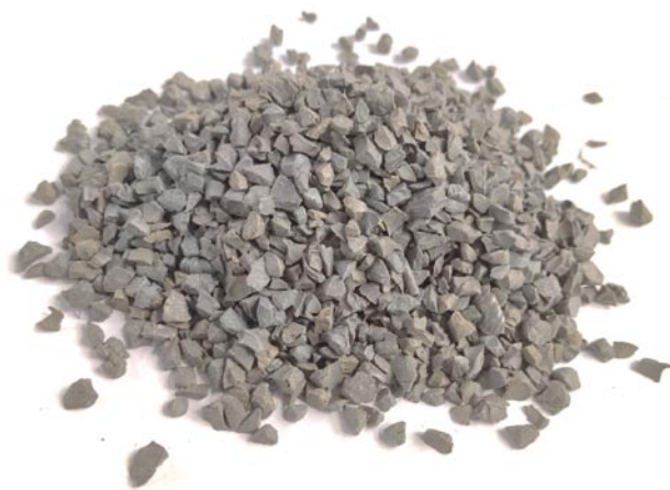
Rys. 3. Kruszywo sztuczne wyprodukowane z mieszanki PET/PVC/OPS
