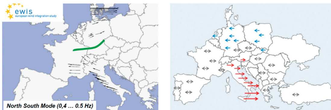
Rys. 7. Struktura geograficzna modu IT 0,38 Hz w opracowanym modelu ENTSO-E CE (po prawej) oraz 0,4–0,5 Hz wg [8] po lewej
