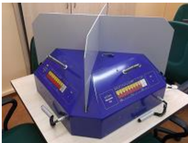
Rys. 1. Podstawowe wyposażenie Laboratorium Badań Olfaktometrycznych – olfaktometr dynamiczny
