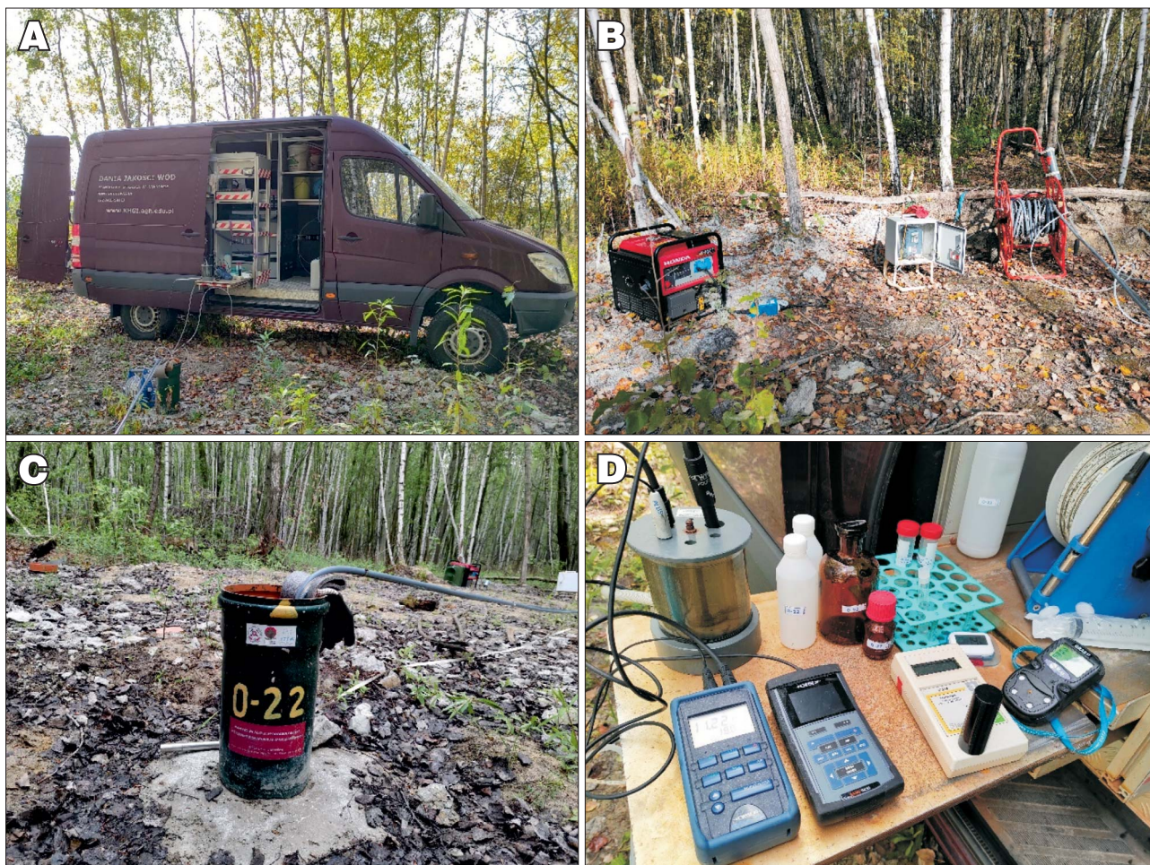
Ryc. 4. Aparatura do terenowych badań wód podziemnych: A – mobilne laboratorium badania jakości wód; B – sprzęt do przepompowania otworu; C – otwór Chmielów O-22 w trakcie pompowania; D – stanowisko pomiarowe. Fot. R. Zdechlik Fig. 4. Equipment for field tests of groundwater: A – mobile water quality testing laboratory; B – equipment for pumping the borehole; C – Chmielów O-22 borehole during pumping; D – measurement station. Photo by R. Zdechlik
