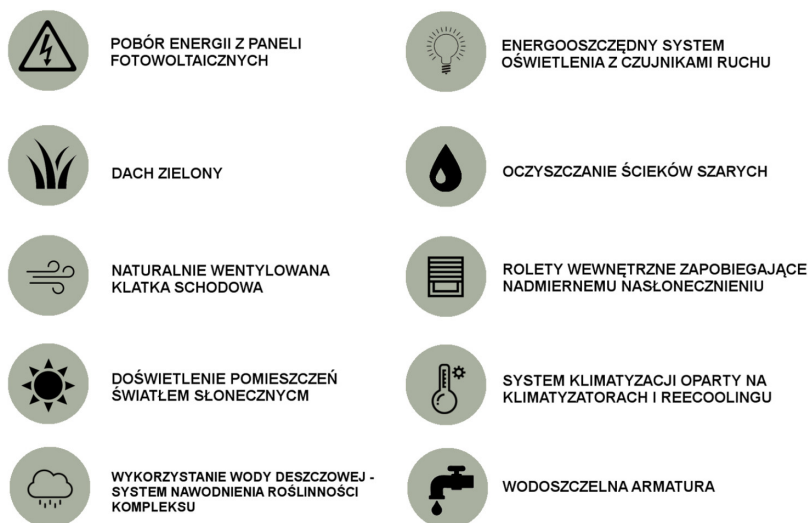
Rys. 10. Schemat rozwiązań ekologicznych i energooszczędnych [3]
