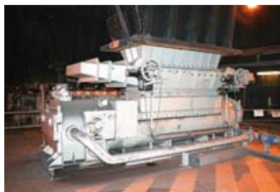
Fot. 4. Grawimetryczne dozowniki Stock, elektrownia Longanet, Wielka Brytania
