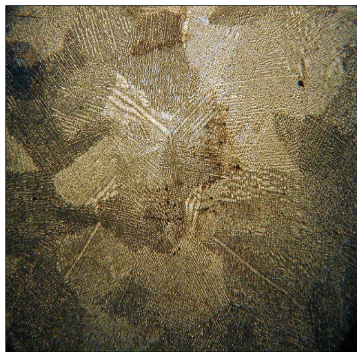
Rys.4. Materiał Wirocer, traw. Mi17Cu, pow. 10x
