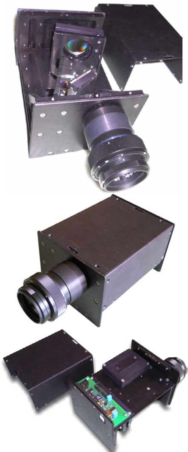
Рис. 2а, б, в. Спектрорадиометр MS – 14 Fig. 2 a, b, c. Spectroradiometer MS – 14
