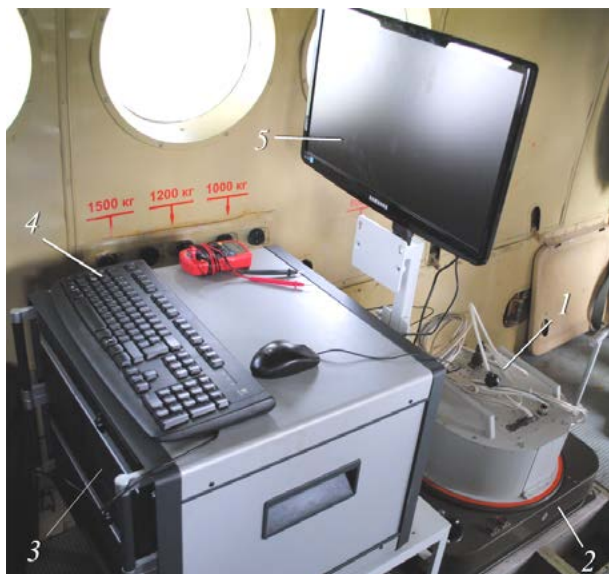
Рис. 9. Система АВИС, установленная на борту самолета АН-2: 1 – блок оптических датчиков; 2 – гиросплатформа PAV-20; 3 – рабочая станция PC; 4 – клавиатура PC; 5 – монитор PC
