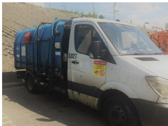
Rys. 2. Śmieciarka mała ładowana z boku o powierzchni załadunkowej 8 m 3
