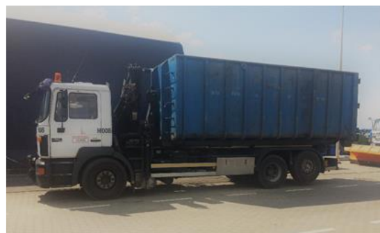
Rys. 6. Hakowiec z załadowanym kontenerem KP34
