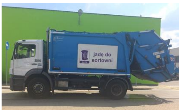
Rys. 1. Śmieciarka średnia o pojemności skrzyni załadunkowej 18 m 3 (pojazd bezpyłowy)
