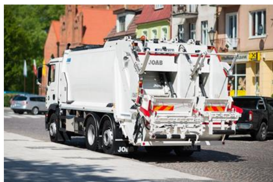
Rys. 3. Śmieciarka z zabudową dwukomorową Ekocel Joab Twin Źródło: Ekocel – katalog produktu
