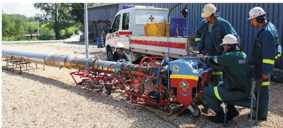
Rys. 10. wyposażenie pogotowia do inertyzacji atmosfery Fig. 10. Equipment of the specialist emergency team for inertization of the mine atmosphere
