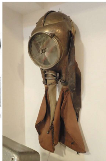
Rys. 4. Aparat oddechowy Dräger 1904 (fotografia: hełm i maska ze zbiorów Sali tradycji OSRG Jaworzno)
