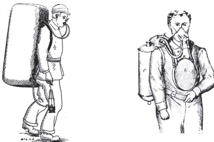
Rys.1. Aparat oddechowy Galiberta 1830 r. (z lewej) i aparat oddechowy Schwanna 1853 r. (z prawej)
