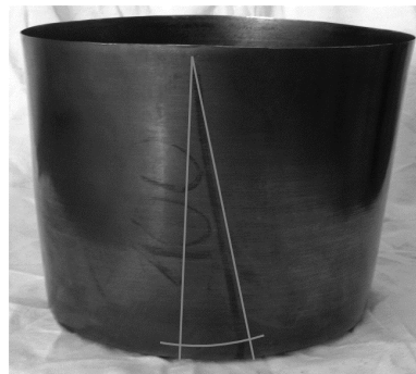
Rys. 5. Przykładowa próbka po procesie ZOWW z zaznaczonym kątem skręcenia materiału względem osi wytłoczki Fig. 5. One of the specimens after flow forming with the materials' angle of twisting in relation to the axis of drawpiece marked
