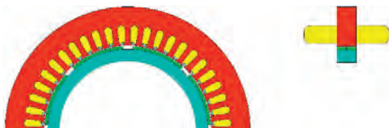
Rys. 2. Wstępny model generatora do obliczenia elektromagnetycznego. n = 1000 obr/min, U_{LL} = 400 V, P_{el} = 20 kW, D_{sz} = 520 mm
