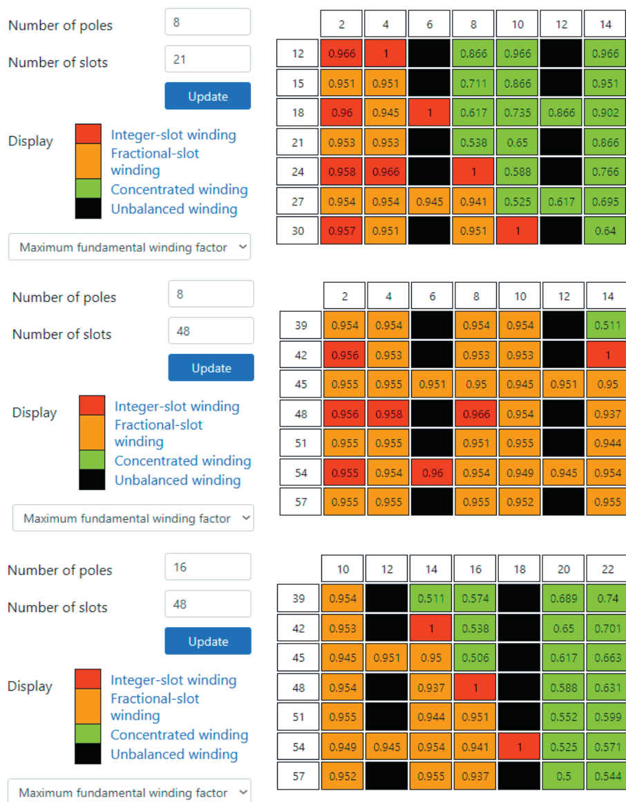
Rys. 4. Kalkulator uzwojeń EMETOR. Podane wartości: wiersze 2p , kolumny Q_s
