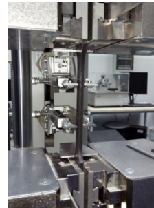
Rys. 2. Próba rozciągania wg ISO 527
