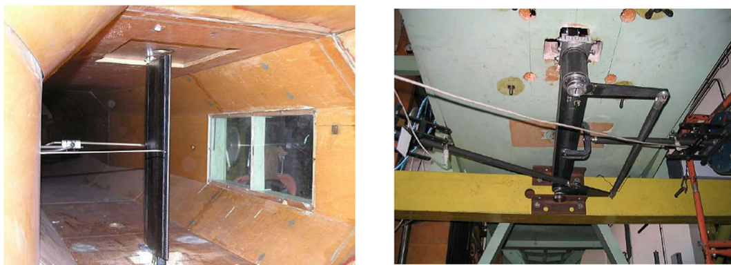
Rys. 1. Obiekt badań w tunelu aerodynamicznym i mechanizm pod przestrzenią pomiarową (sprężyny K_h i K_\alpha są realizowane za pomocą wzбудników), zdjęcia z [5].
