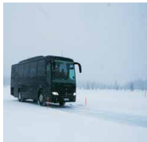
Ślalom Mercedesa Tourismo K na nawierzchni o różnym współczynniku przyczepności
