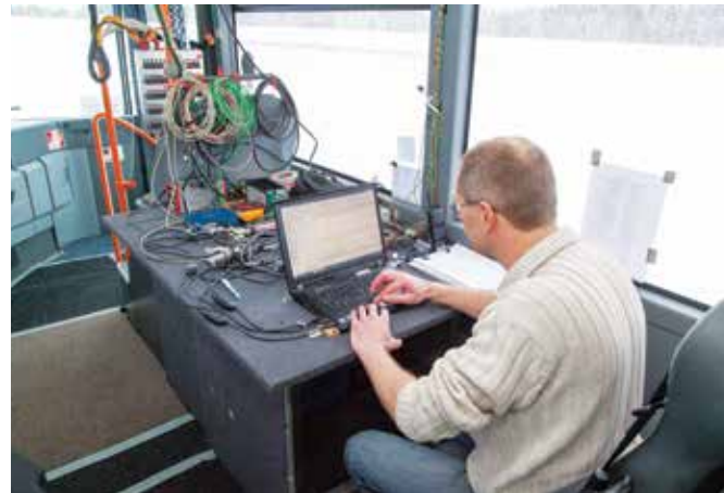
Faza testowa poprzedzona jest okresem przygotowań, w ramach których autobusy wyposażane są w sprzęt pomiarowy
