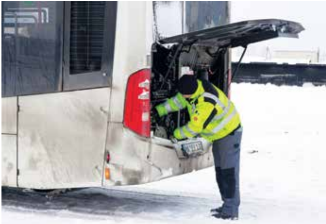
Przed próbą zimnego rozruchu autobus stoi przez 48 godzin z otwartą klapą silnika, aby wszystkie płyny eksploatacyjne osiągnęły temperaturę otoczenia (fot. Daimler)
