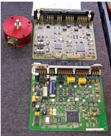
Porównanie sterowników ATC starej i nowej generacji
