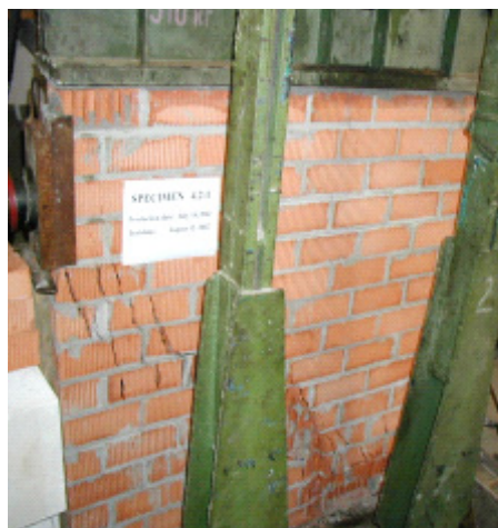
Rys. 3.4. Charakter uszkodzenia badanych modeli ściany: a) bez pionowych obciążeń ściskających mur; b) przy pionowych obciążeniach ściskających
