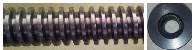
Rys. 5. Widok śruby Tr16x4 i nakrętki z poliamidu
