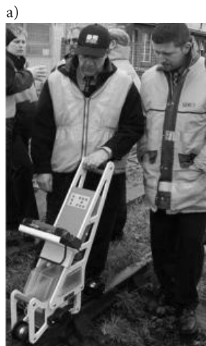
Rys. 3. Technika defektoskopii ultradźwiękowej [11]
