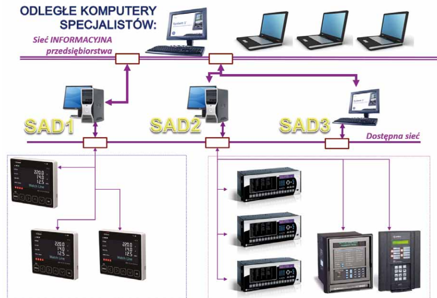
Rys. 2. Rozwiązanie systemowe umożliwiające wnioskowanie o stanie technicznym, bazujące na analizach widmowych prądów/napięć
