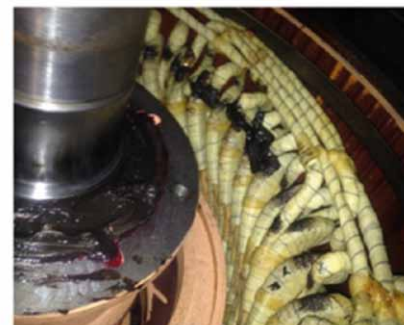
Rys. 6. Uszkodzone łożysko silnika oraz zanieczyszczone uzwojenia stojana
