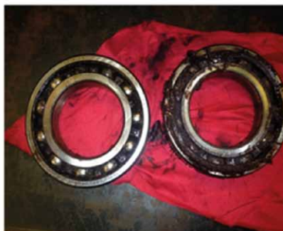
Rys. 6. Uszkodzone łożysko silnika oraz zanieczyszczone uzwojenia stojana
