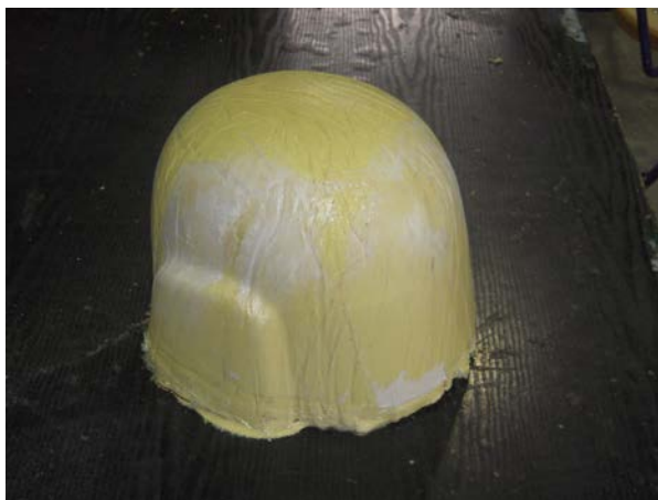
Rys. 3. Czerep z kompozytu aramidowego powleczony warstwą polietylenu, wykonany z zastosowaniem aramidowej warstwy pośredniej
