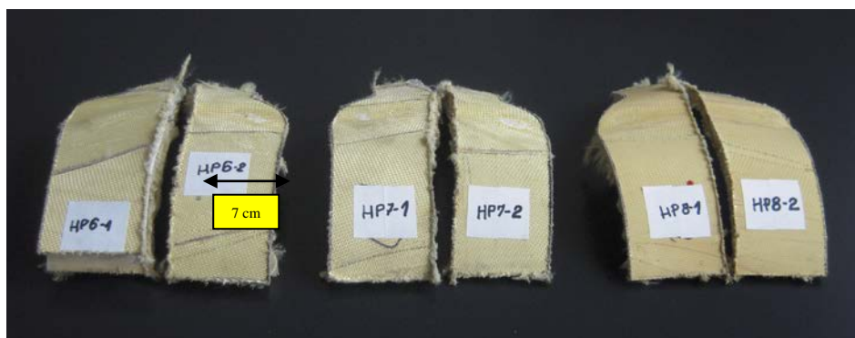
Rys. 6. Próbki kompozytu do badań siły odrywania warstw kompozytowego czerepu hełmu kulo- i odłamkoodpornego
