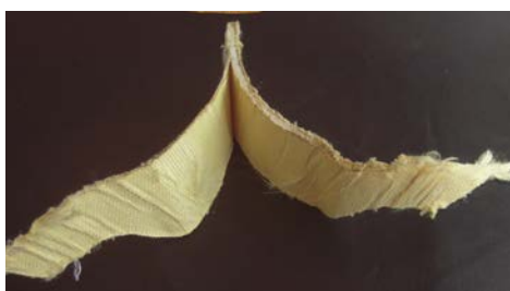
Rys. 9. Międzywarstwowa faktura powierzchniowa kompozytu aramidowego w czerepie helmu
