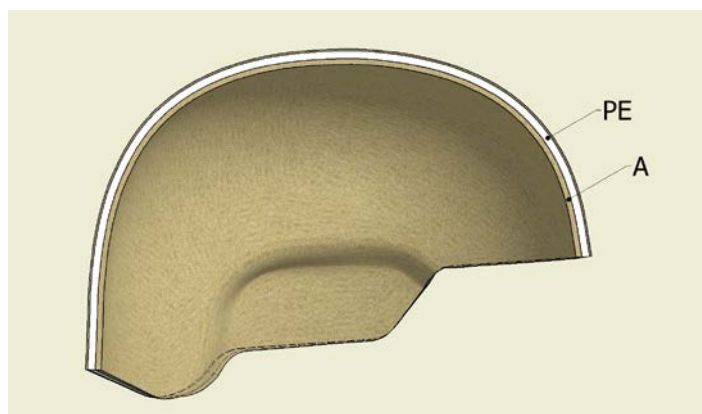
Rys. 5. Budowa czerepu hełmu z kompozytu hybrydowego: PE - wielowarstwowy kompozyt polietylenowy DYNEEMA HB 80, A - wielowarstwowy kompozyt aramidowy TWARON CT 736
