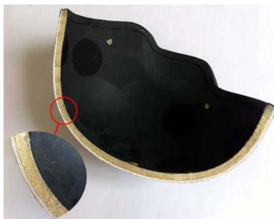
Rys. 4. Przekrój czerepu hełmu o budowie hybrydowej – aramidowo – polietylenowej
