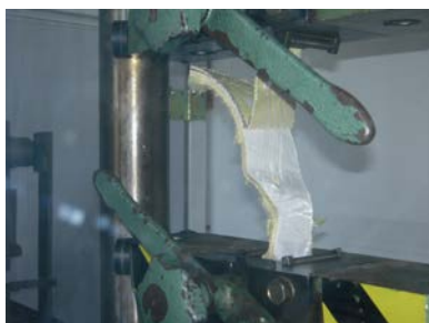
Rys. 8. Próbką kompozytu hybrydowego pochodząca z czerepu helmu poddana próbie odrywania – w tym przypadku międzyfazowego
