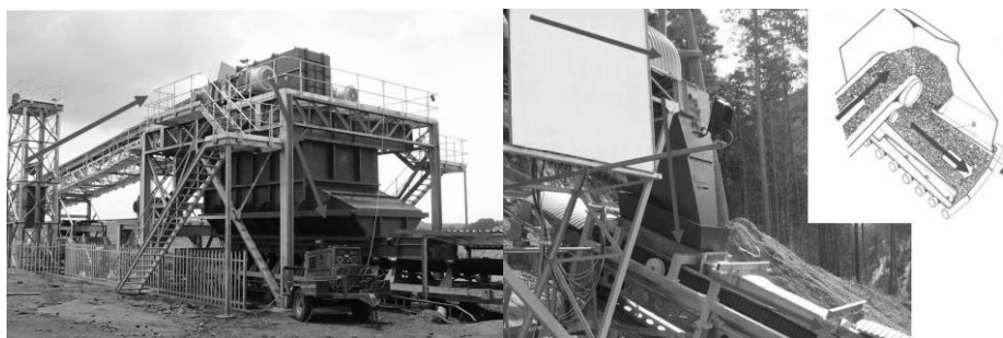
Rys. 3. Widok stacji przesypowych: a) równoległej; b) kątowej [7]
