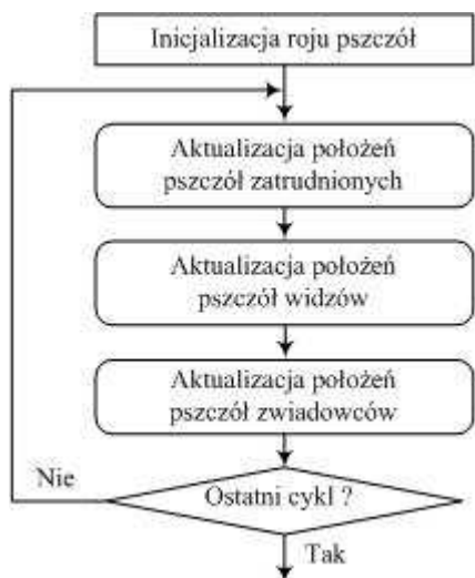
Rys. 4. Schemat blokowy zawierający fazy algorytmu sztucznej kolonii pszczół
