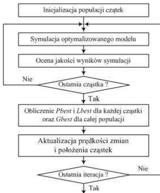
Rys. 7. Schemat blokowy algorytmu optymalizacji cząstek
