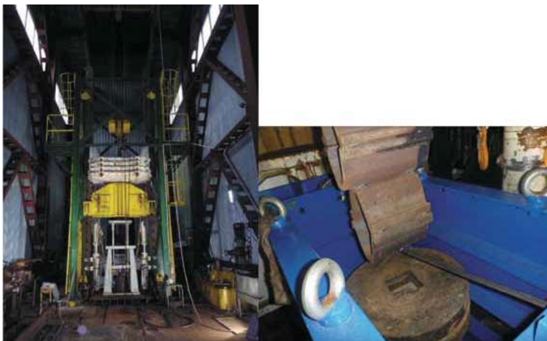
Rys. 2. Stanowiska do badań w zakresie obciążenia osiowego i poziomego Fig. 2. Test stand for axial and horizontal loads analyses
