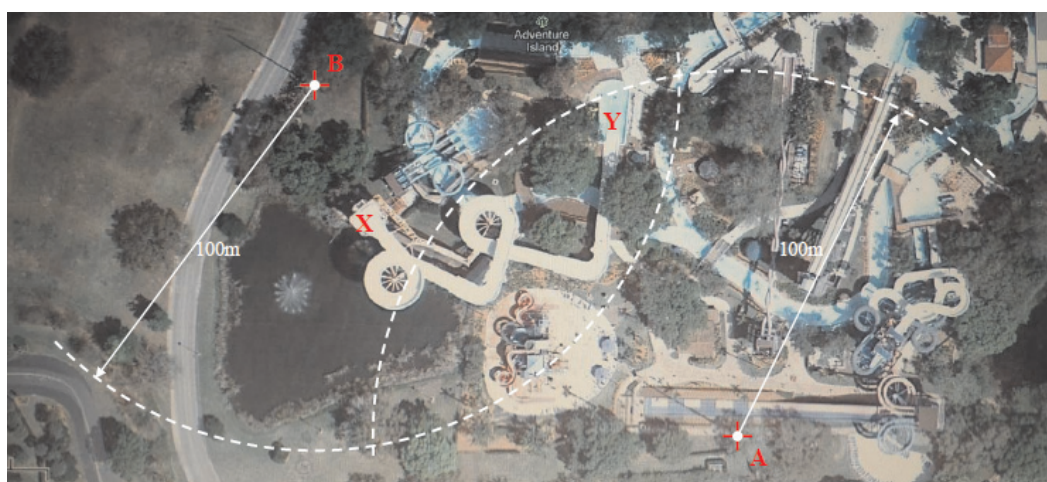
Rys. 10. Śmiertelny wypadek na drodze X-Y (trasa ześlizgu wodnego) zdarzył się między „zwodami ESE” A-B, których deklarowany zasięg ochrony oznaczono strzałkami
