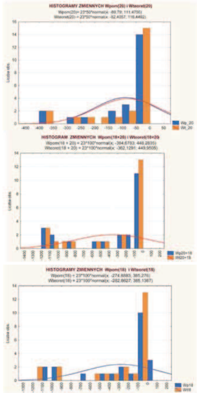
Rys. 6. Histogramy rozkładu obniżeń W_{pom}(\cdot) ; W_{teoret}(\cdot) dla trzech skupień oddziaływania ścian górniczych (20; 18). Rozkłady istotnie różne od N(m_W; \sigma_W)
