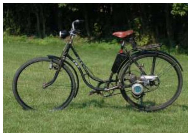
Rys. 8. Widok silnika mocowanego przy tylnym kole [1]
