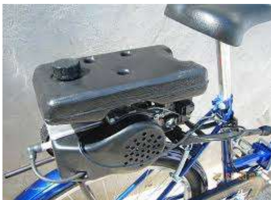
Rys. 15. Widok układu napędowego z silnikiem typ 029 [1]
