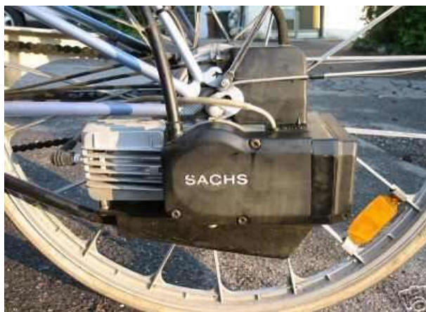
Rys. 4. Widok silnika zintegrowanego z piastą koła [1]
