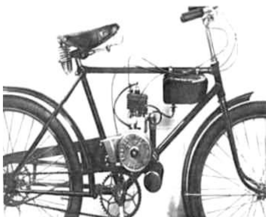
Rys. 6. Widok silnika umieszczonego centralnie na ramie [1]
