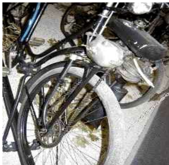
Rys. 5. Widok roweru z silnikiem umieszczonym nad przednim kołem [1]
