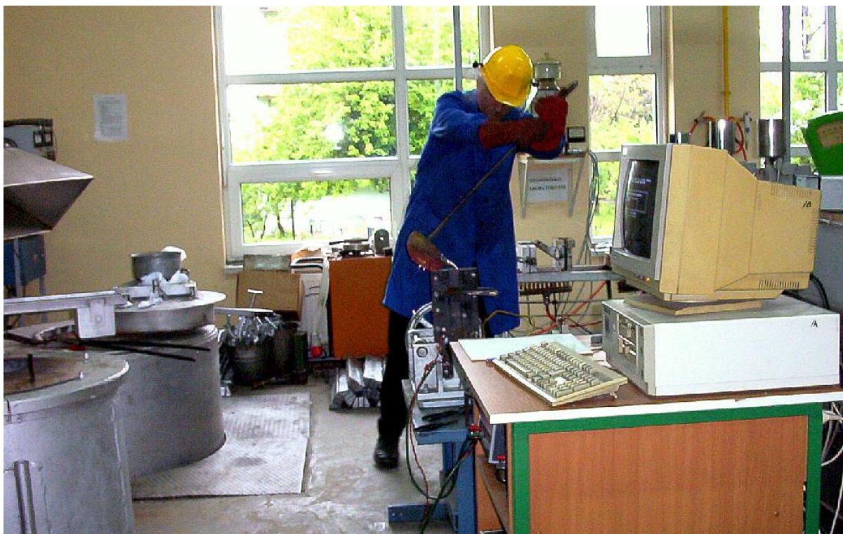
Rys. 1. Stanowisko badawcze do analizy krzepnięcia i krystalizacji stopów aluminium metodą ATD-AED [1,2] Fig.1. Research stand for crystallization and solidification analysis of aluminium alloys using the ATD-AED method [1,2]
