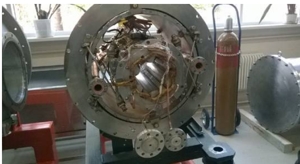
Fot. 5. Element kriostatu boosteru z multipolowym elektromagnesem korekcyjnym
