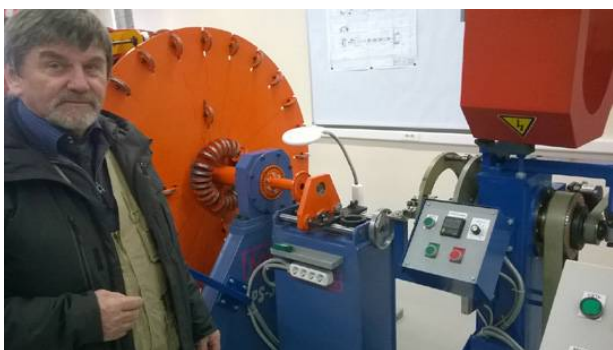
Fot. 2. Urządzenie do produkcji nadprzewodnikowego kabla (prąd max 18 kA) przeznaczonego do budowy uzwojeń elektromagnesów NICA
