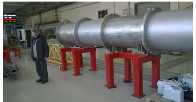
Fot. 7. Wstępne łączenie elementów kriostatu systemu NICA w hali montażowej (z archiwum ZIBJ)
