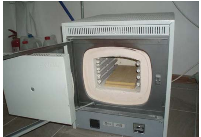
Fot. 5. Piec do badania odporności na szok termiczny kruszyw (fot. S. Zaśkiewicz)
