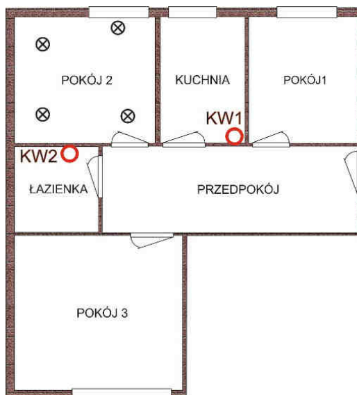
Rys. 1. Rzut lokalu mieszkalnego: KW - kanały wentylacji naturalnej, ⊗ - punkty pomiarowe w pomieszczeniu sypialni
