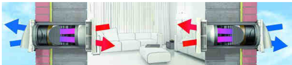
Rys. 5. Schemat budowy rekuperatora ściennego [17]
