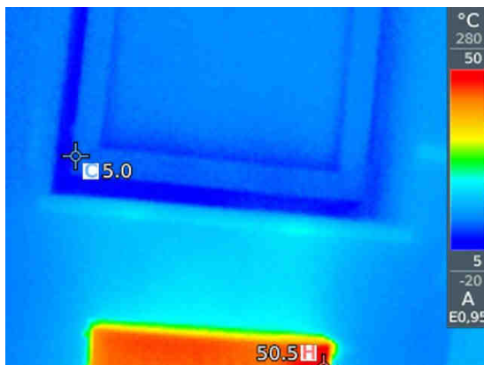
Rys. 4. Zdjęcie otwartego okna wykonane kamerą termowizyjną Fig. 4. Infrared image of open window
