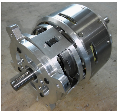
Rys. 1. Wykonany prototyp bezzszczotkowej maszyny z magnesami trwałymi przystosowany do zamontowania w układzie hybrydowym samolotu bezzałogowego
