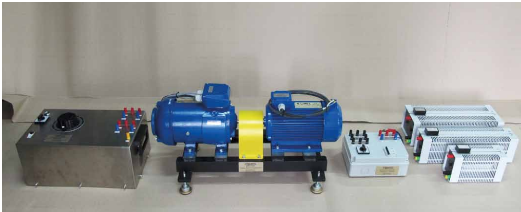
Rys. 5. Zestaw elektromaszynowy, napędzany silnikiem obcowzbudnym prądu stałego, do badania prądnicy 3-fazowej synchronicznej z magnesami trwałymi prądu przemiennego
