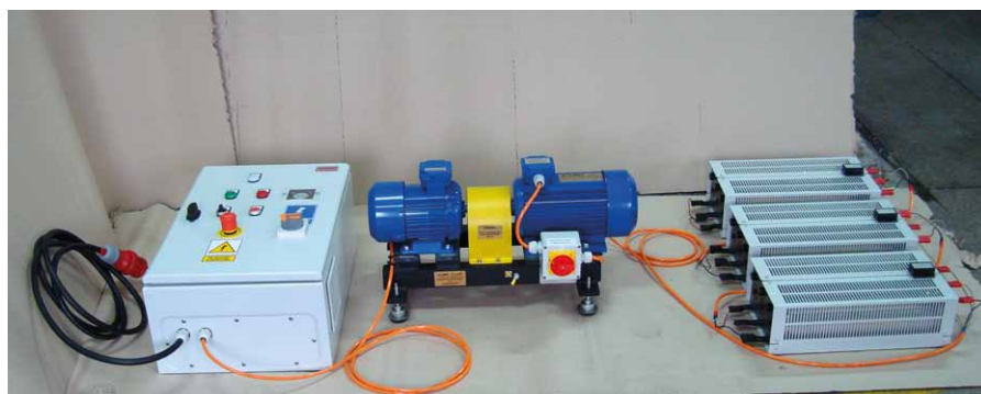
Rys. 6. Zestaw elektromaszynowy, napędzany silnikiem indukcyjnym klatkowym, do badania prądnicy 3-fazowej synchronicznej z magnesami trwałymi prądu przemiennego
