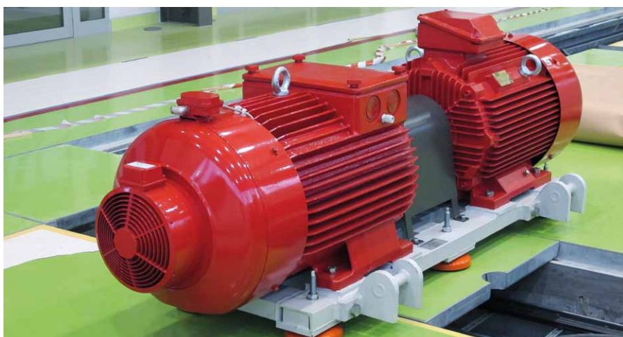
Rys. 3. Zestaw emulujący działanie rzeczywistej elektrowni wiatrowej z generatorem asynchronicznym pierścieniowym – maszyną dwustronnie zasilaną
