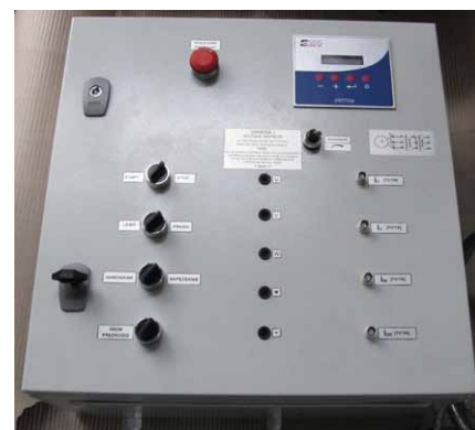
Rys. 7. Energoelektroniczny układ zasilająco-sterujący do silnika synchronicznego z magnesami trwałymi
