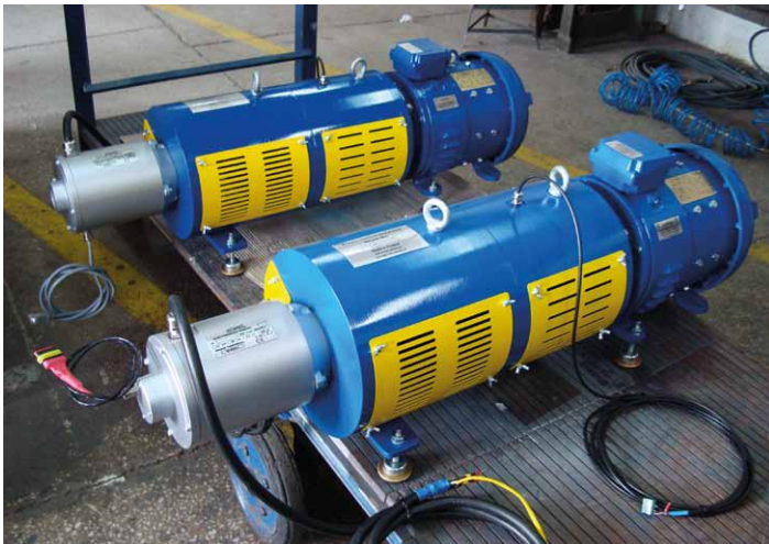
Rys. 8. Zestaw napędowy z silnikiem PMSM sterowanym sinusoidalnie i z silnikiem BLDC sterowanym trapezowo
