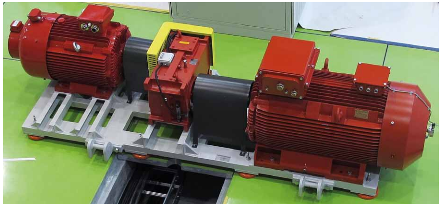
Rys. 2. Zestaw emulujący działanie rzeczywistej elektrowni wiatrowej z wielobiegunowym generatorem synchronicznym ze wzbudzeniem z magnesami trwałymi
