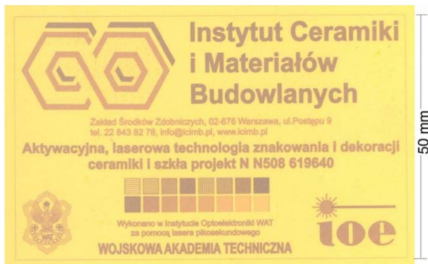
Rys. 10. Przykład ilustrujący zakres uzyskanych kontrastów i rozdzielczości: wizytówka wykonana 2,5 mm poniżej płaszczyzny ogniskowej. Szkliwo KT-J15
