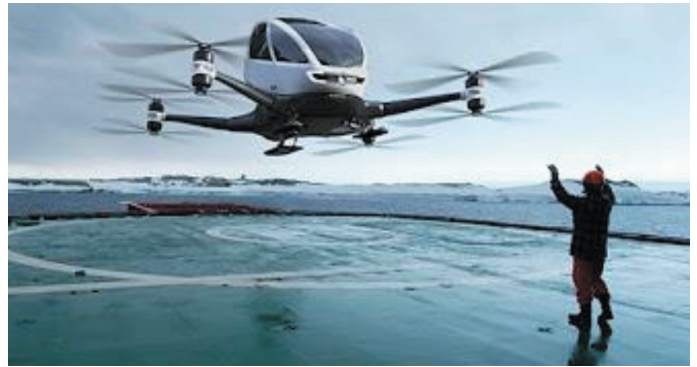
Fot. 6. Chiński latający pojazd autonomiczny Ehang 184
