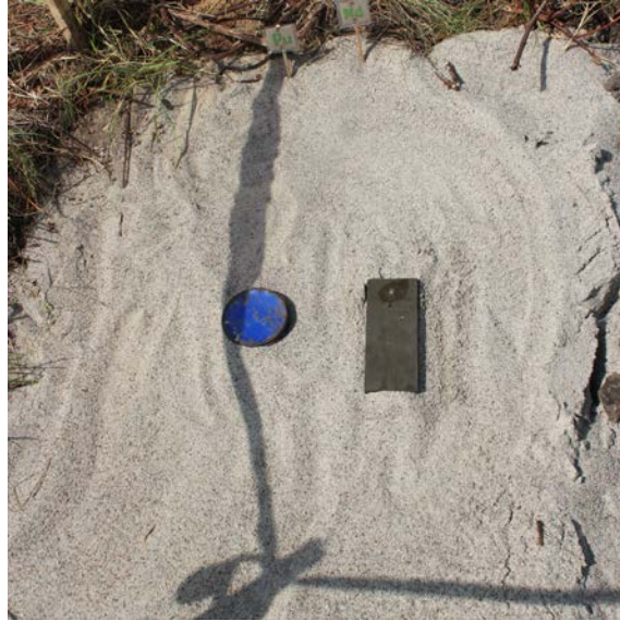
Rys. 5. Mina drewniana i metalowa puszka przed zakopaniem na zewnętrznym polu pomiarowym
