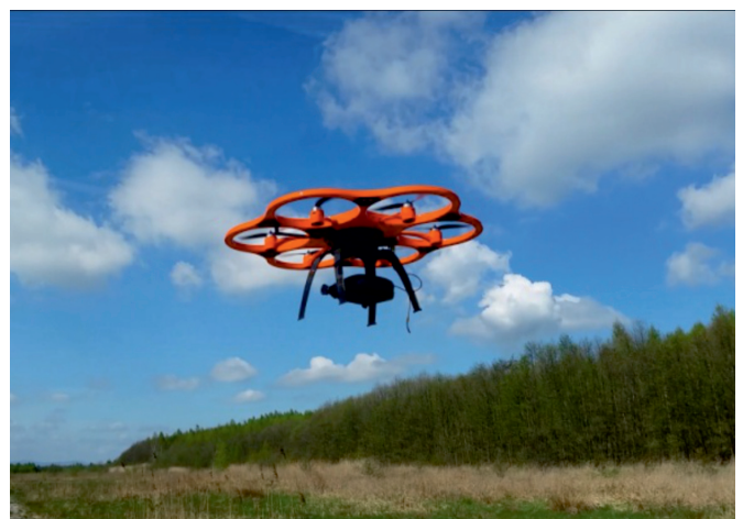
Fot. 3. Hexakopter używany do skaningu laserowego
