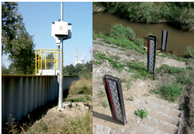
Fot. 6. Monitoring zwierciadła wód powierzchniowych – rzeka Miedzianka Fot. 6. Monitoring of water level in Miedzianka river
