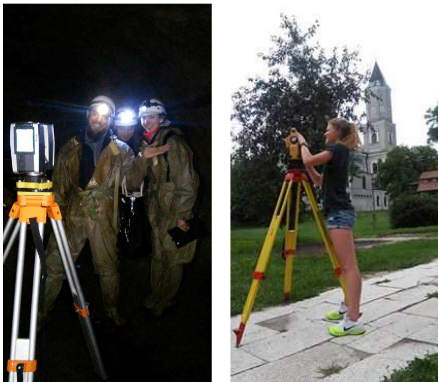
Rysunek 2. Pomiary: a – wyrobisk w Podziemnym Mieście Osówka, b – wychylenia wież kościoła w Opactwie Sióstr Benedyktynek w Jarosławiu
